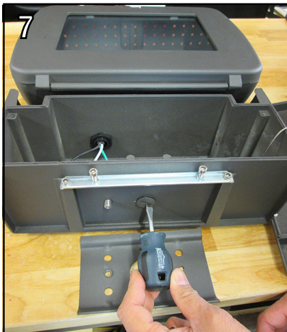
Dévisser le bouchon d'accès pour le filage électrique à l'intérieur du luminaire.
